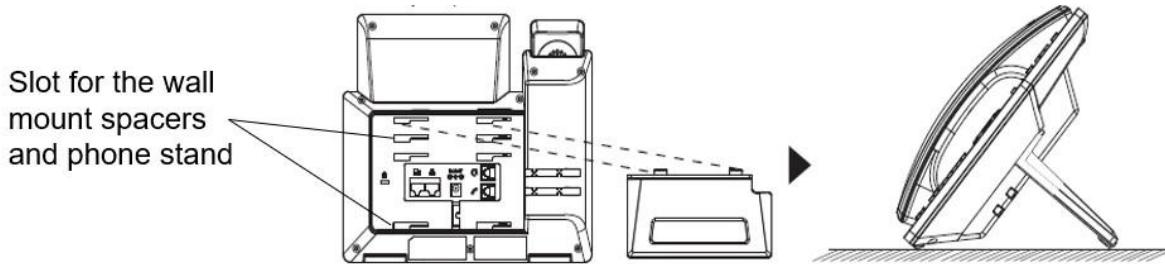
图 2: GRP26XX 上的电话支架和安装插槽
