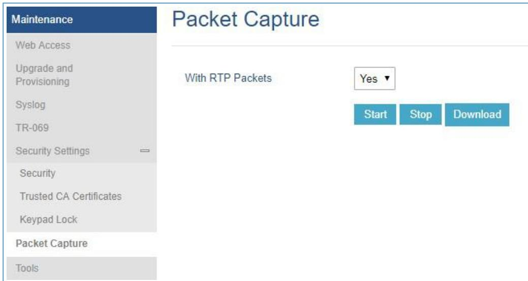
GRP2615 内置有数据包捕获功能。相关选项位于维护→数据包捕获。
