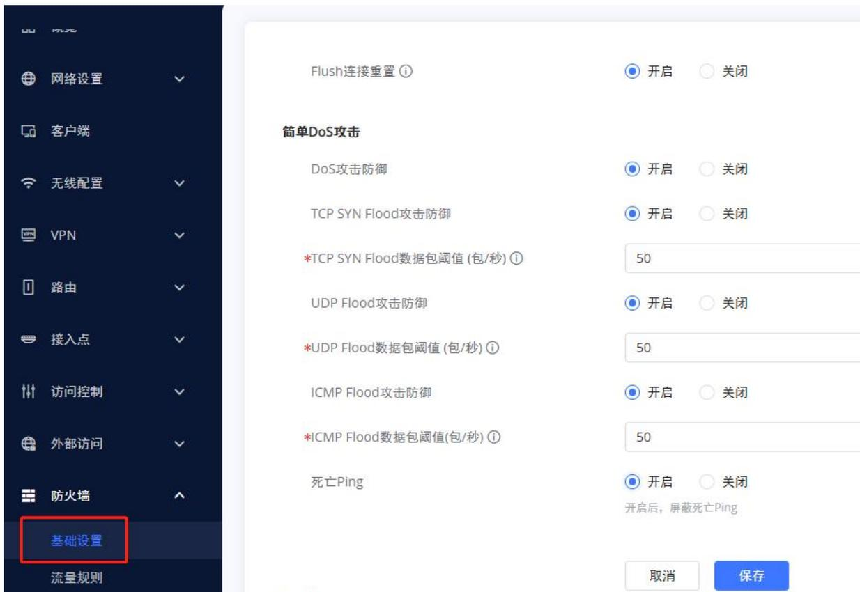
图 65 防火墙基础设置
