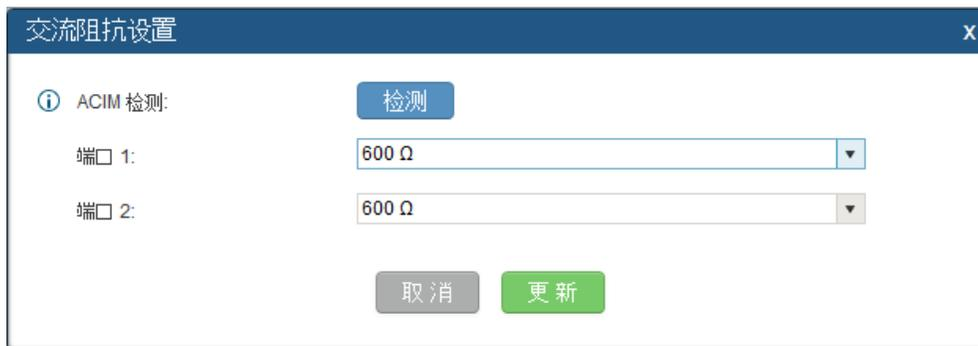
图 28: FXO 端口交流阻抗设置
